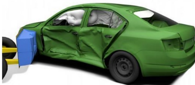
Obr. č. 18. Boční náraz Škoda - PC simulace [8]
