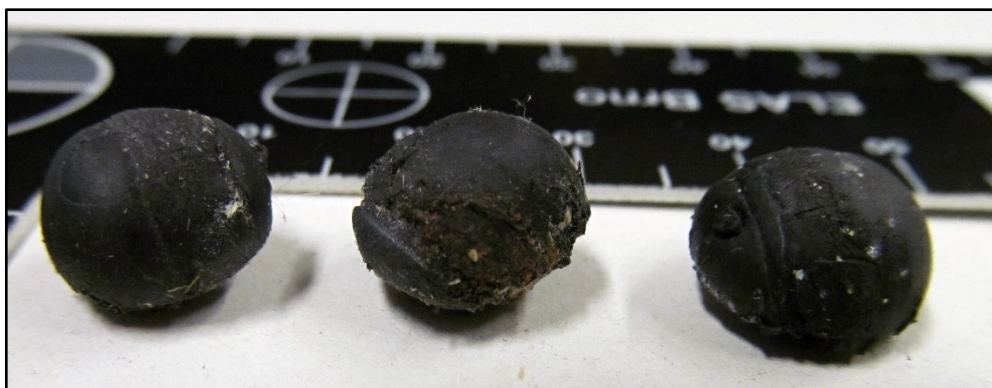
Obr. 6 Deformované střely 9 mm Luger Rubber b
