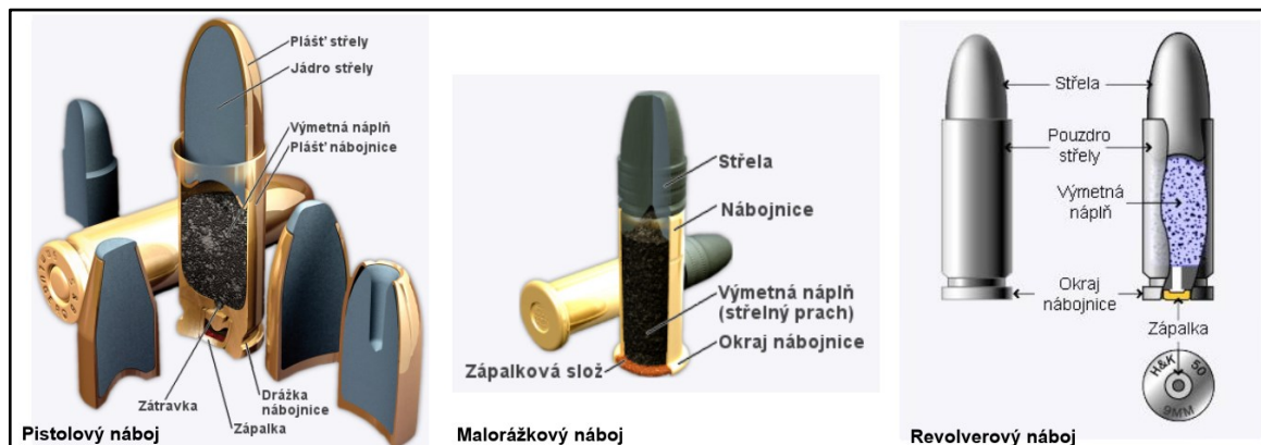
Obr. 5 Řezy jednotlivými druhy nábojů [15, 16]
