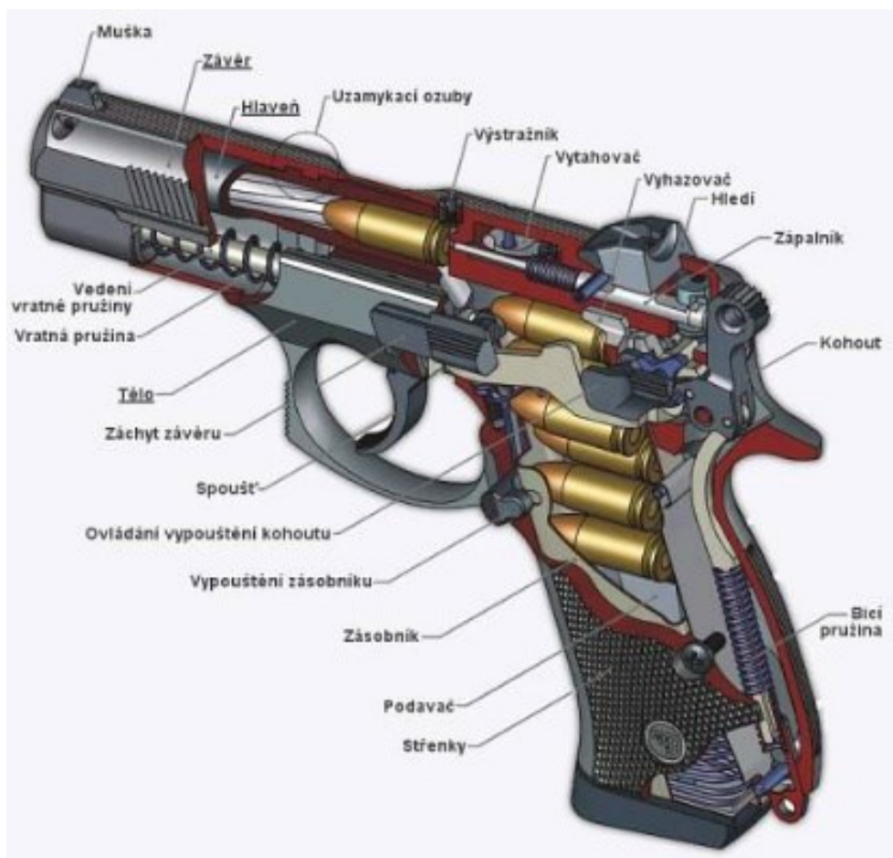
Obr. 1. Komponenty pistole CZ 75 D [2]
