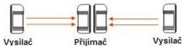
Obr. 21: Zobrazení funkce infračervených bariér [22]
