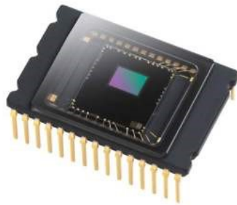
Obr. 30: Ukázka CMOS čipu [28]
