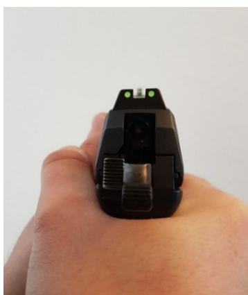
Obr. 10 Mířidla (zaostřeno na hledí)
