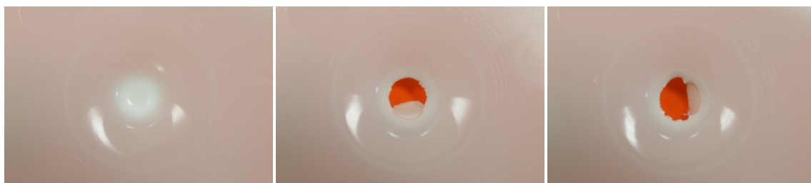
Obr. 71 Deformace zkušebního tělesa z HDPE po pádové zkoušce při energii pádu vlevo 30 J, 50 J, 100 J
