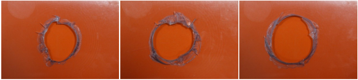
Obr. 63 Deformace zkušebního tělesa ze SAN po pádové zkoušce při energii pádu vlevo 150 J, 200 J, 230 J
