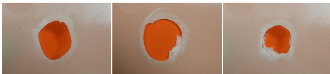
Obr. 68 Deformace zkušebního tělesa z PP 30% GF po pádové zkoušce při energii pádu vlevo 30 J, 50 J, 100 J
