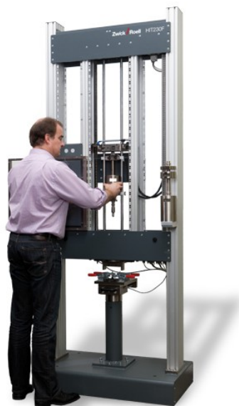
Obr. 4 Padostroj HIT230F pro zkoušení upravených vláknitých kompozitů [24]
