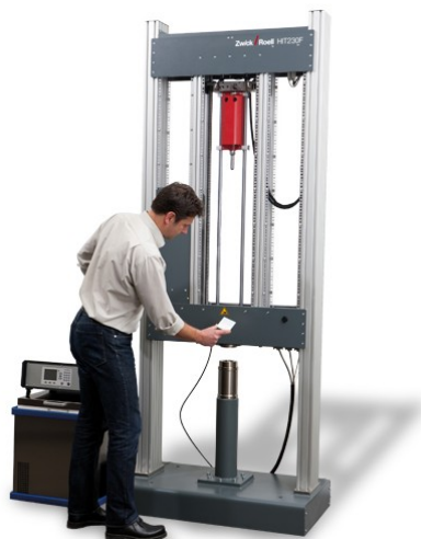
Obr. 3 Padostroj HIT230F pro zkoušení plastů [24]
