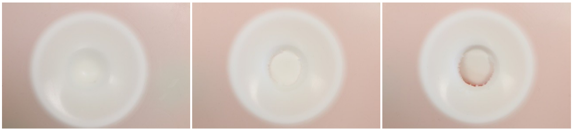
Obr. 65 Deformace zkušebního tělesa z PP po pádové zkoušce při energii pádu vlevo 30 J, 50 J, 100 J
