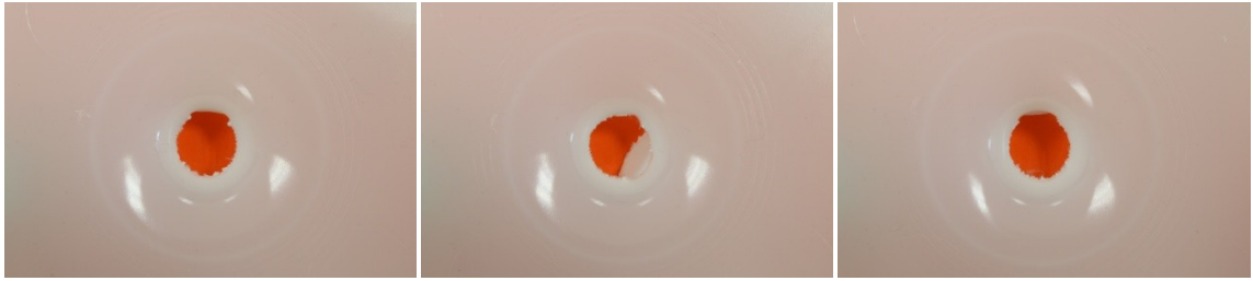
Obr. 72 Deformace zkušebního tělesa z HDPE po pádové zkoušce při energii pádu vlevo 150 J, 200 J, 230 J
