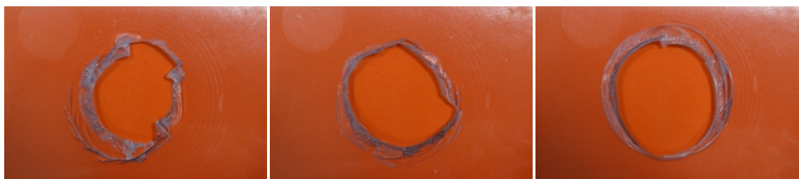
Obr. 62 Deformace zkušebního tělesa ze SAN po pádové zkoušce při energiích pádu vlevo 30 J, 50 J, 100 J
