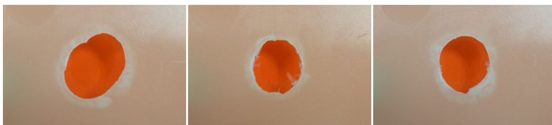
Obr. 69 Deformace zkušebního tělesa z PP 30% GF po pádové zkoušce při energii pádu vlevo 150 J, 200 J, 230 J
