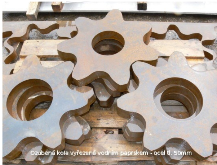
Obr. 11. Ozubená kola vyřezaná vodním paprskem [16]
