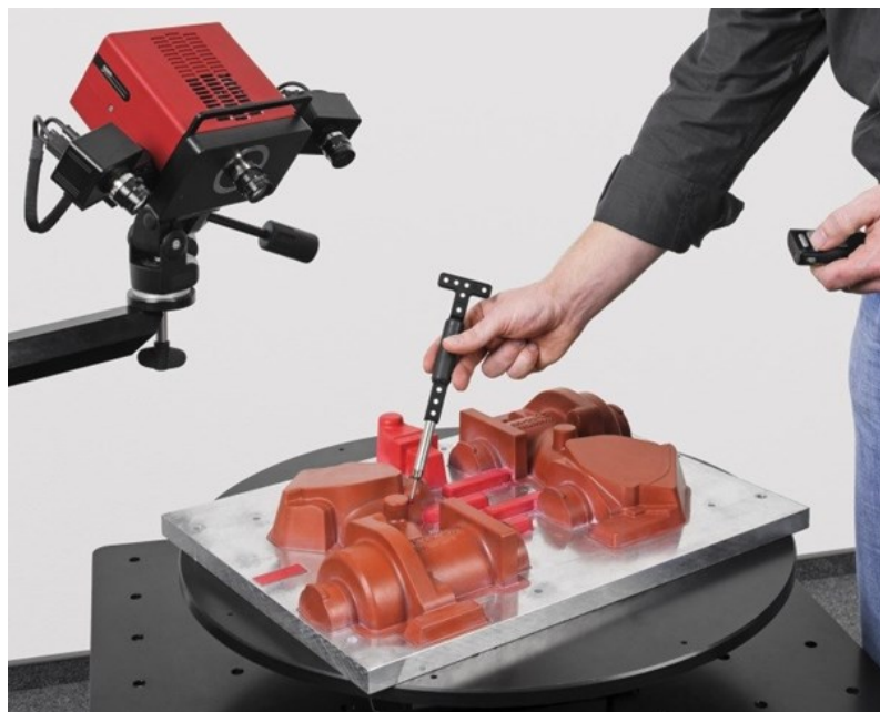
Obr. 36. ATOS I skener jako trackovací zařízení [19]
