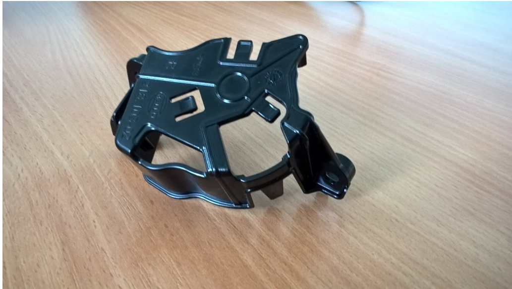
Obr. 43. Hotový výrobek z hloubené dutiny ve tvárnici
