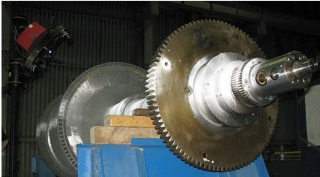
Obr. 39. Skenování rotoru turbíny [19]
