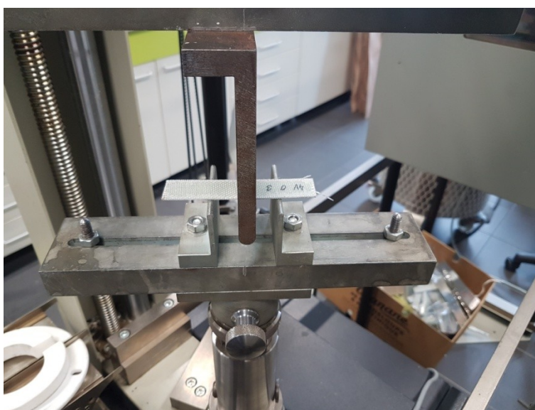
Obr. 49 Nachystaný vzorek před zkouškou na ohyb
