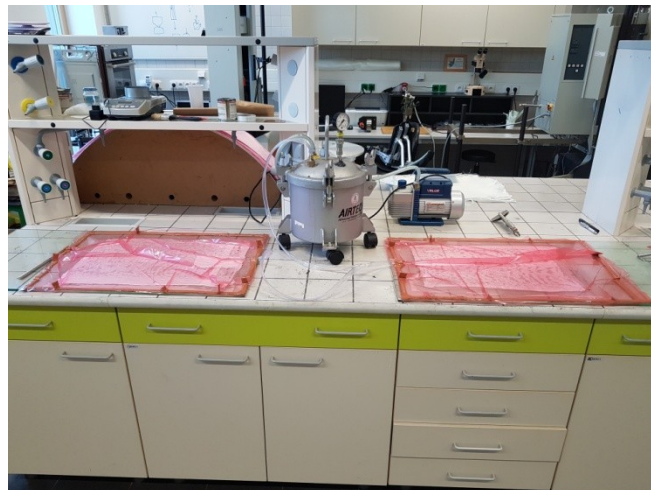
Obr. 44 Příprava vzorků ručním laminováním
