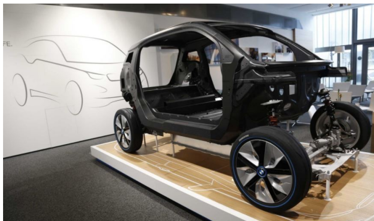
Obr. 15 Konstrukce vozu BMW i3 z uhlíkových vláken [7]
