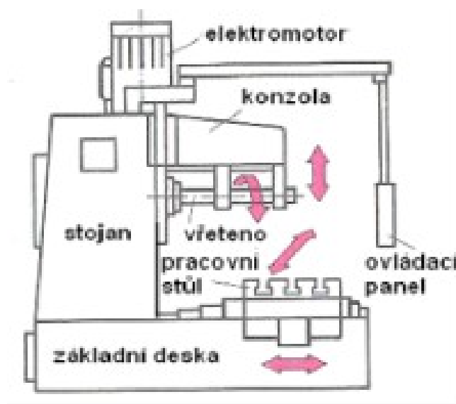
Obr. 11. Rovinná bruska s vodorovným vřeteníkem a pohyblivým stolem [12]
