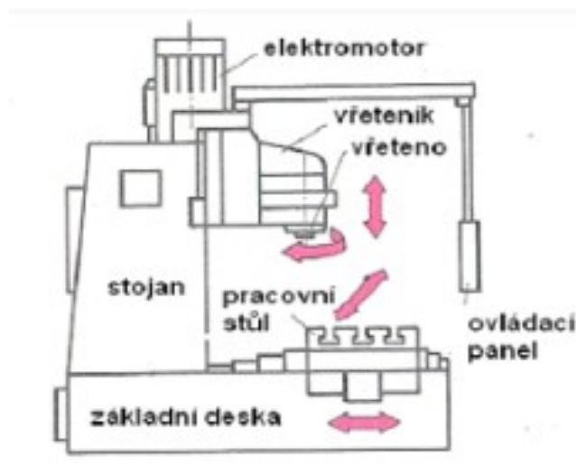
Obr. 13. Rovinná bruska se svislým vřeteníkem a pohyblivým stolem [12]
