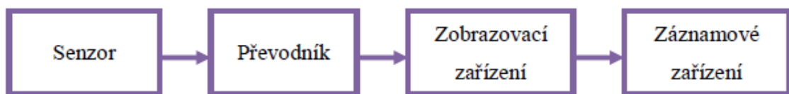
Obr. 4 Schéma a princip měřicího zařízení [16]
