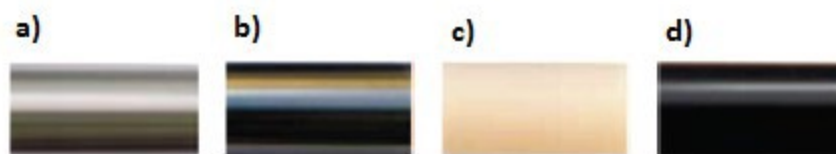
Obr. 18 Materiály pro stopky dotyků [8] a) ocel, b) karbid wolframu, c) keramika, d) uhlíková vlákna
