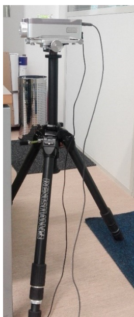
Obr. 2. Ukázka sestavení laserinterferometru XL – 80.
