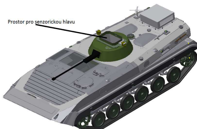
Obr. 37 Vozidlo BVP s prostorem pro sensorickou hlavu
