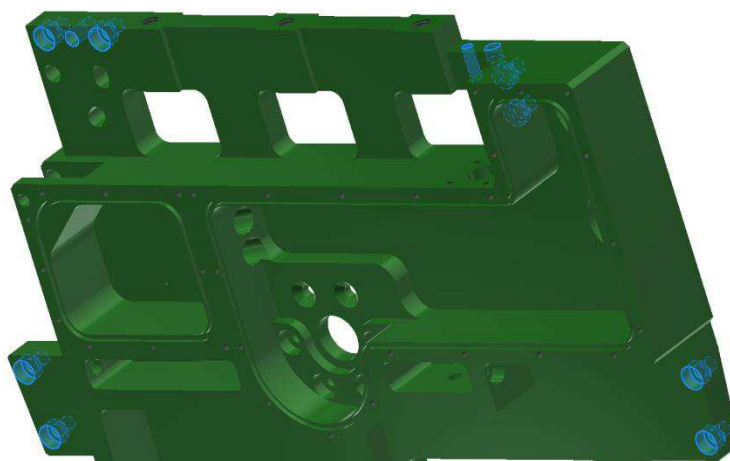
Obr. 56 Díry pro výztuhy – levá bočnice
