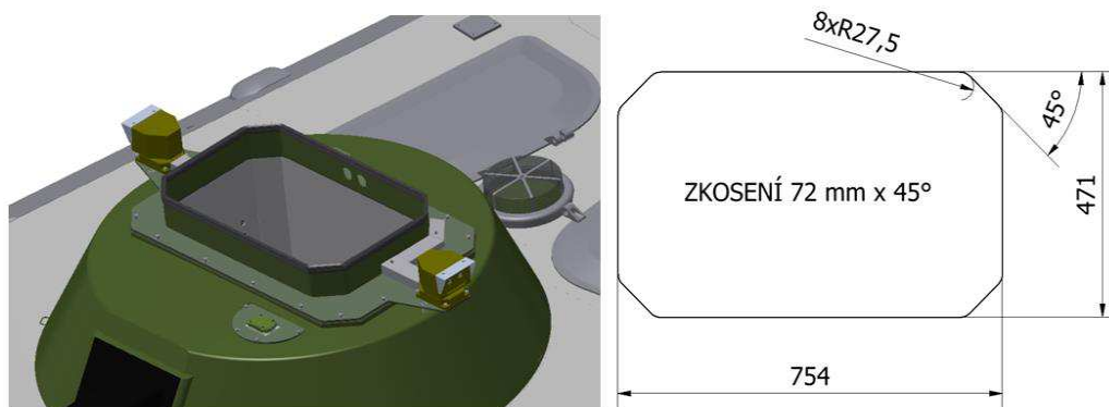
Obr. 38 Detail a rozměry vany pro sensorickou hlavu
