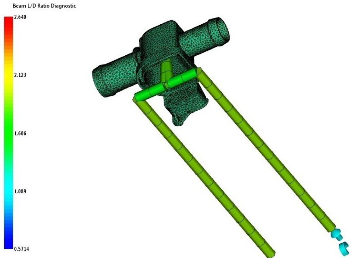
Obr. 61 Spodní pohled na hlavní temperační systém vykreslený v Autodesk Moldflow s upravenou L/D diagnostikou včetně dutiny formy
