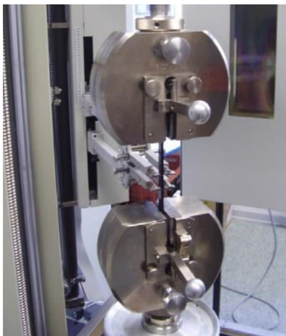
Obr. 48 Upnuté zkušební těleso ve stroji pro tahovou zkoušku [32]
