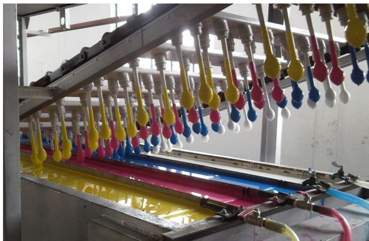
Obr. 22 Možný princip nanášení nátěrové hmoty máčením [13]
