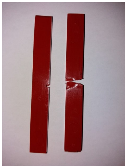
Obr. 47 Zkušební těleso opatřené vrubem V (před provedením rázové zkoušky v ohybu a po provedení zkoušky)
