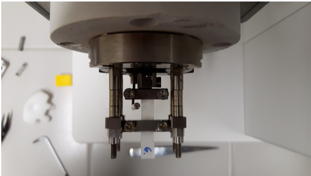
Obr. 28 – Správné upnutí zkušební vzorku v čelistech měřicího přístroje
