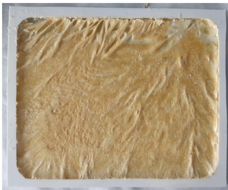
Obr. 25 – Výsledný materiál vzniklý síťováním kyseliny hyaluronové pomocí DVS
