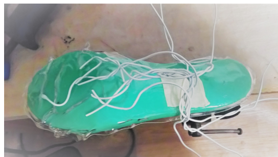
Obr. 17 Tvarování drátu na podešev
