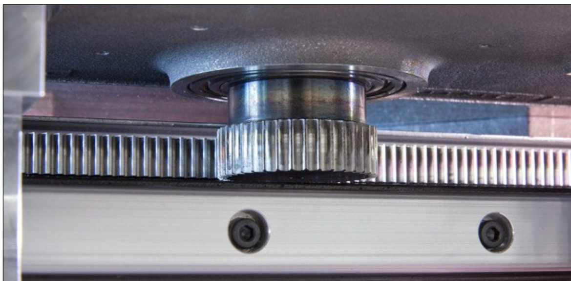
Obrázek 28 Ozubený hřeben ve spojení s pastorkem (Vlastní zpracování)
