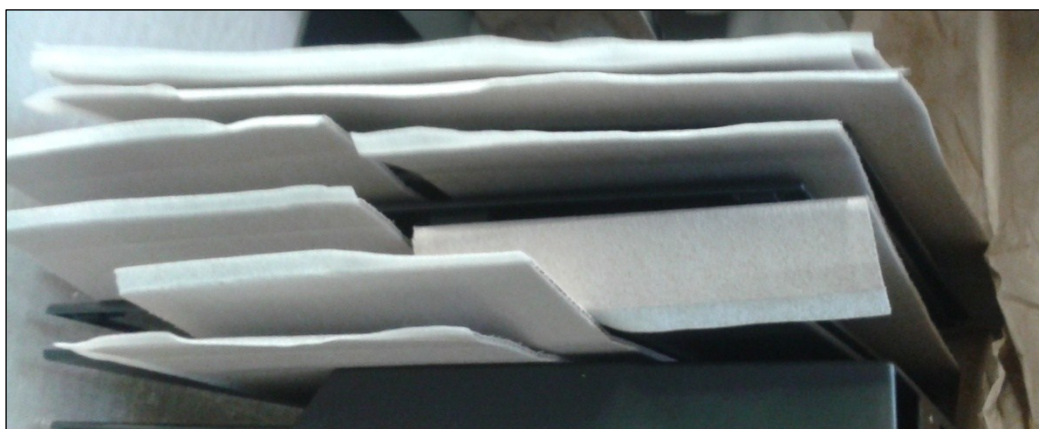
Obrázek 32 Správné skladování bočních plastových krytů, proložených kartonem (Vlastní zpracování)
