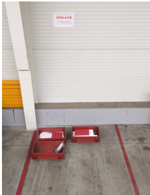
Obrázek 26: Izolační sklad neshodných výrobků zjištěných během výstupní kontroly (Interní materiály společnosti)
