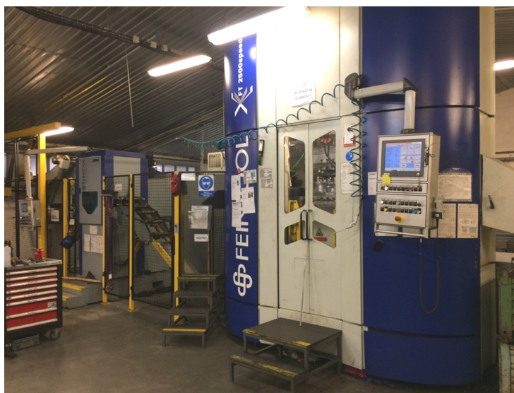
Obrázek 17: Technologie přesného stříhu FEINTOOL (Interní materiály společnosti)
