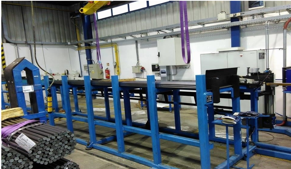
Obrázek 20 – Podavač vstupních tyčí (vlastní zpracování)
