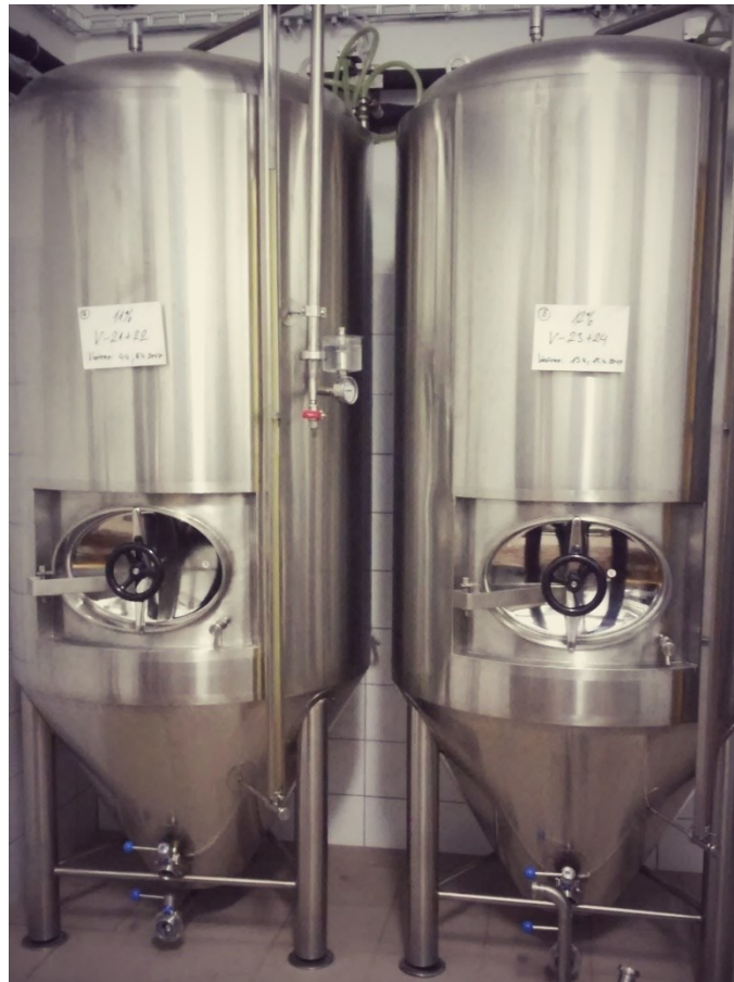
Obrázek 4 – Cylindrokónické tanky (Vlastní foto)
