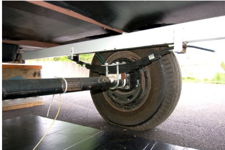
Obr. 21. Aplikace listové pružiny na nápravě [33]
