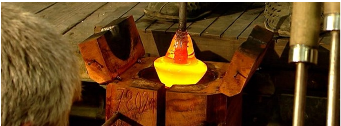
Obr. 1. Fúkanie skla do formy
