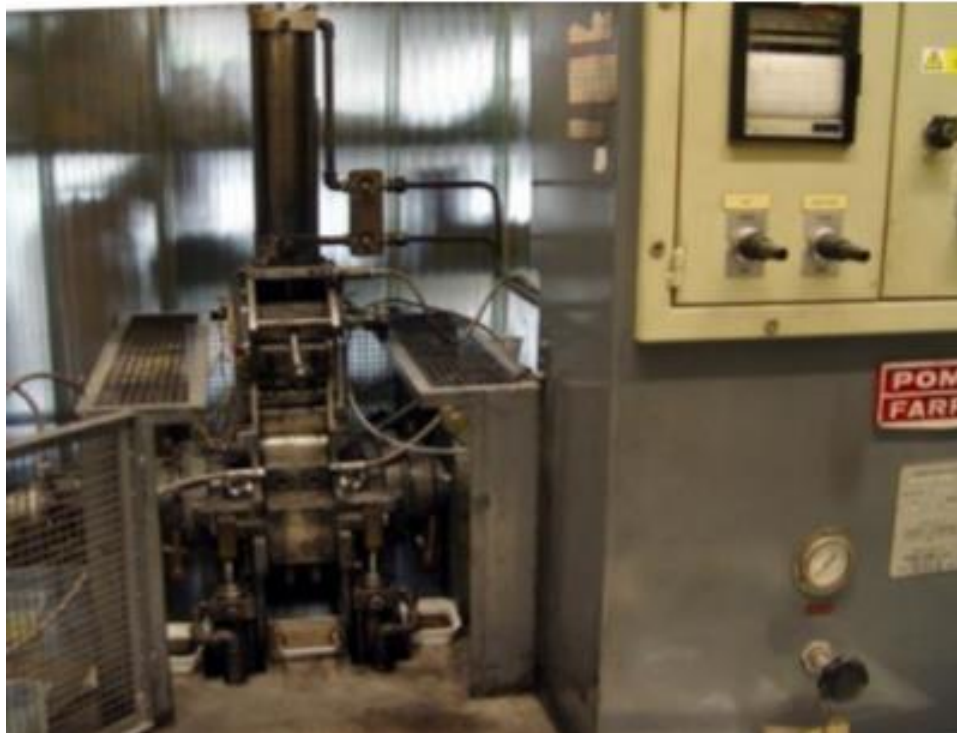
Obr. 11 Integrální hnětič POMINY FARREL BANBURY MIX
