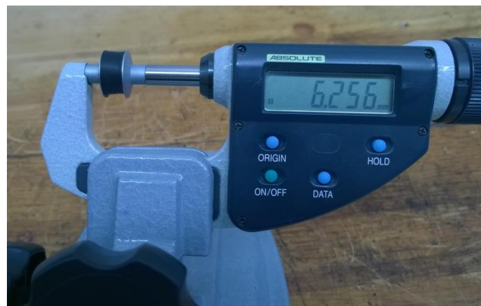
Obr. 16 Měření tloušťky vzorků pomocí tloušťkoměru
