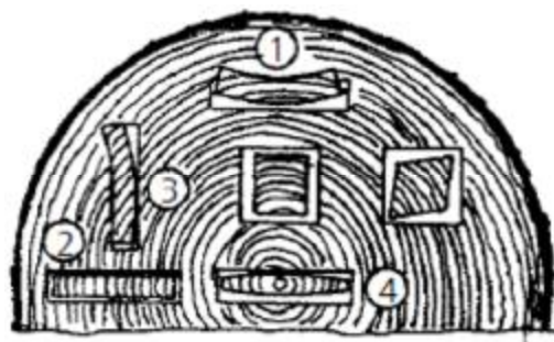
Obr. 2 Tvarové změny prvků způsobené sesycháním
