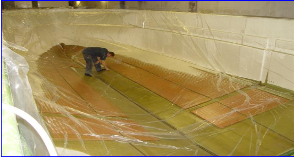
Obr. 8 Vakuové prosycování- výroba lodí
