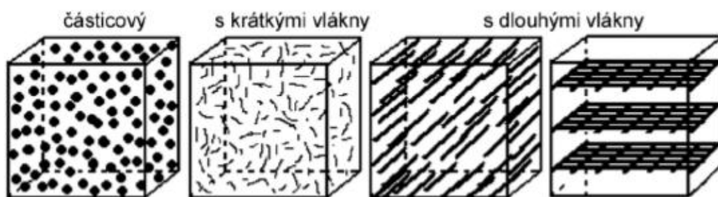
Obr. 1 Geometrické tvary výztuže [8]
