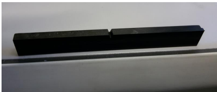
Obr. 23. Vrub 2mm ve zkušebním vzorku
