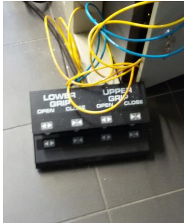
Obr. 25. Pedálové ovládání čelistí trhacího stroje
