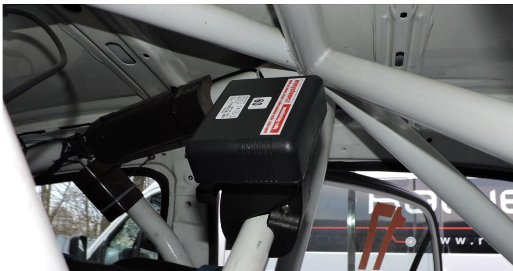
Obr. 1. Montáž GPS jednotky s držákem
