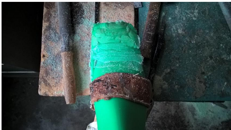
Obr. 32. Aplikace extra materiálu na špici.
