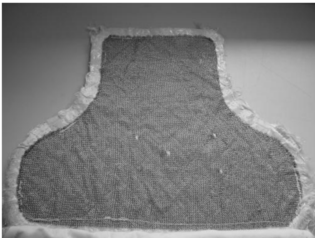
Obrázek č. 15: Reprezentativní ochrana proti nožům – kovové pletivo podporované aramidem
