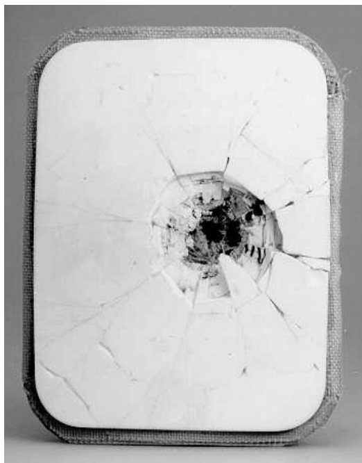
Obrázek č. 2: Silikátový plát oxidu hlinitého podporován kompozitem navrhován na zneškodnění vysoko výkonných střel
