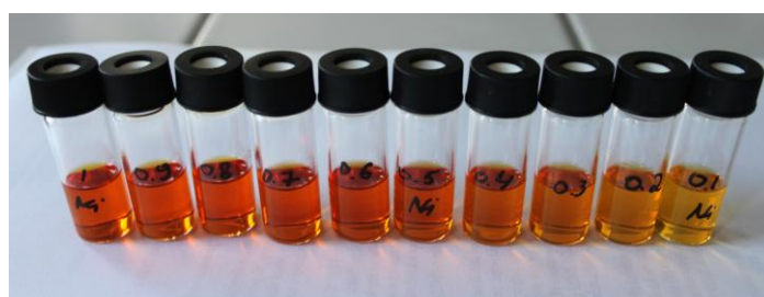
Obrázek 26 - Změna odstínu barvy při komplexaci unimeru s ionty \text{Ni}^{2+}
