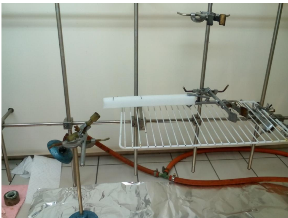
Obr. 29: Ukázka měření podle normy UL94HB
