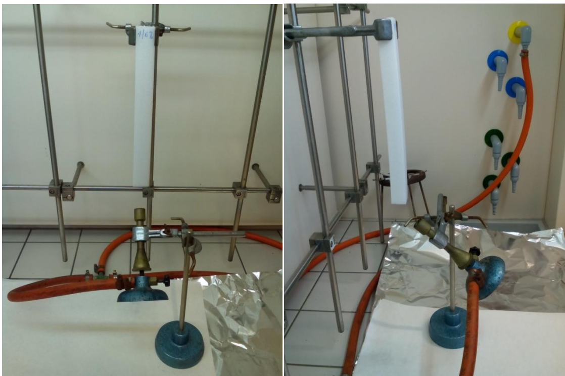
Obr. 30: Ukázka měření podle normy UL94V – pohled zepředu (vlevo), pohled z boku (vpravo)
