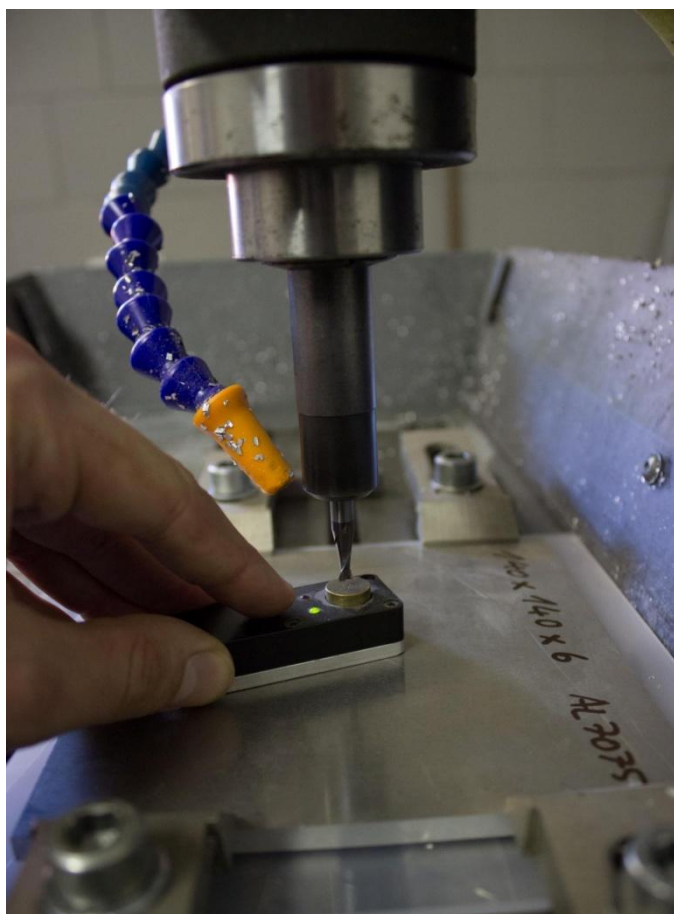
Obr. 42 Měření výšky nástroje
