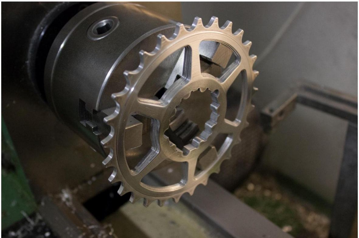
Obr. 48 Zaleštění povrchu na soustruhu
