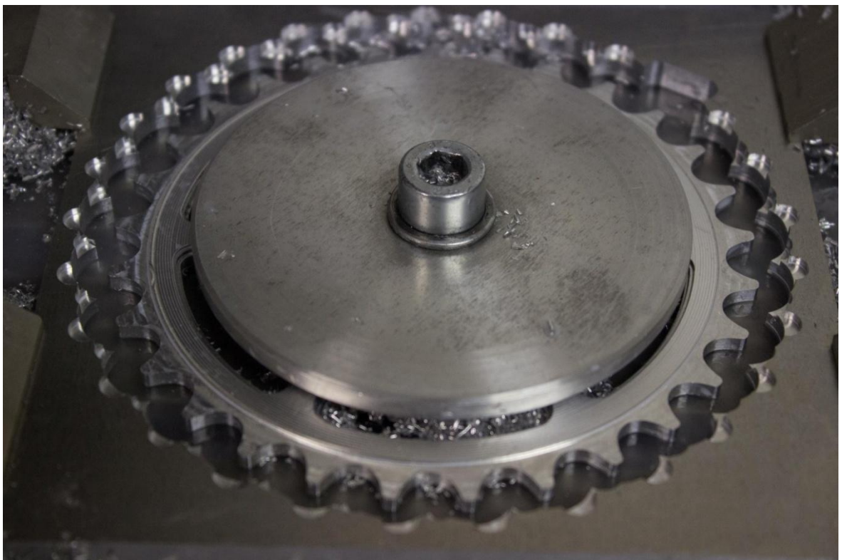
Obr. 47 Uchycení přes střed a obrobení ozubení
