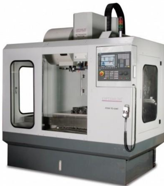
Obr. 12 Univerzální CNC Frézka Optimum F210 TC
