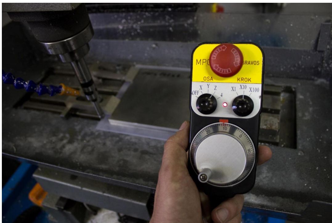
Obr. 41 Najíždění rohu obrobku sodnou pomocí ovladače
