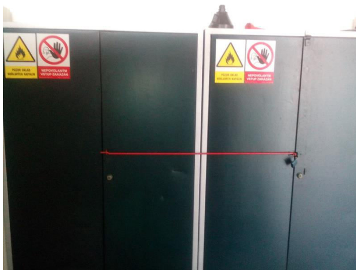
Obr. 8. Skříně pro skladování hořlavých kapalin [36]
