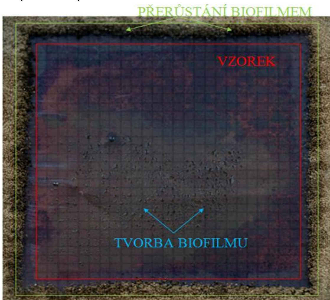
Obrázek 12. Zobrazení mřížky a ohraničujících čtverců (zelený a červený čtverec) pro určení přerůstání a tvorby biofilmu
