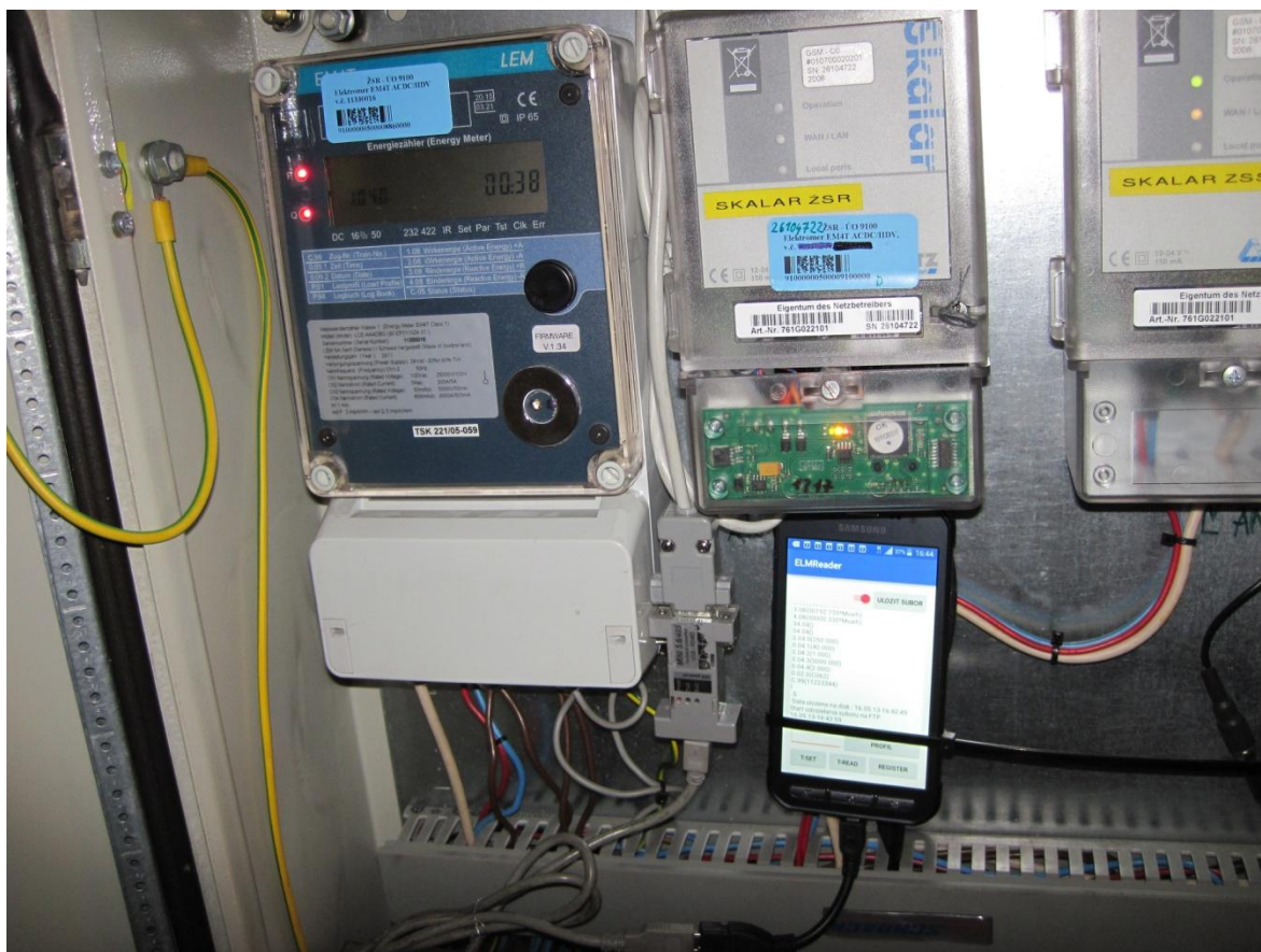
Obrázok 35 Inštalácia telefónu do meracej skrine lokomotívy Škoda
