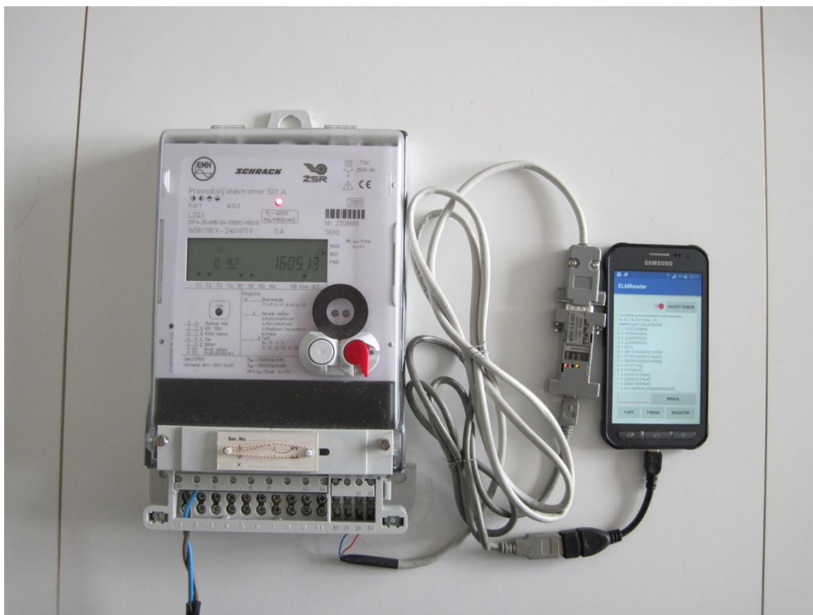
Obrázok 31 Testovanie aplikácie s elektromerom EMH LZQJ
