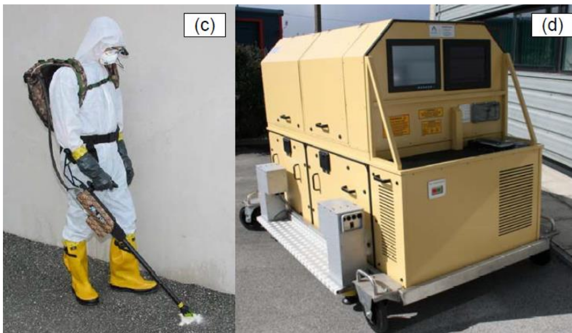
Obr. 6. Prototyp přenosného LIBS zařízení (c), prototyp mobilního standoff LIBS systému pro detekci reziduí výbušnin na vzdálenost 100 m a více (d) [20]
