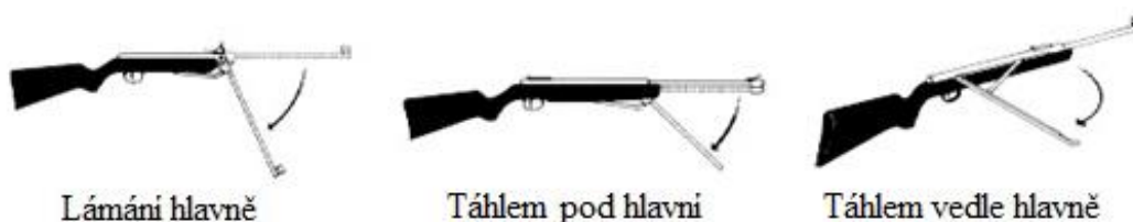
Obr. 13. Způsoby natahování vzduchovky [26]
