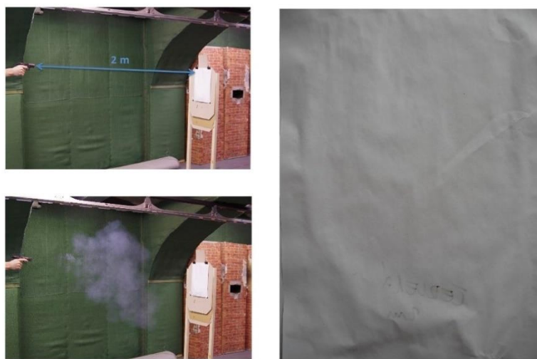
Obr. 81. Obrazec povýstřelových zplodin ze vzdálenosti 2 m [vlastní zdroj]
