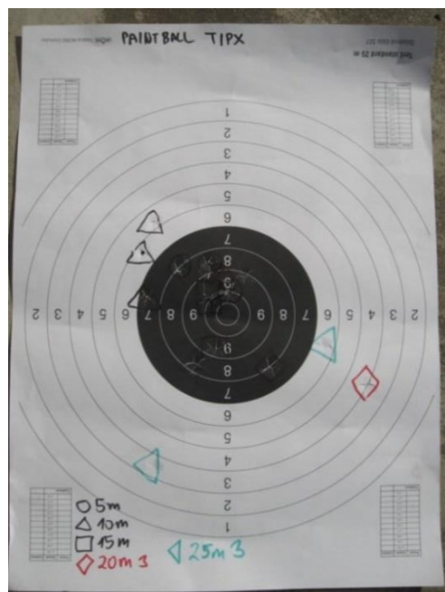
Obr. 58. Rozptyl paintballové pistole Tippmann TiPX [vlastní zdroj]
