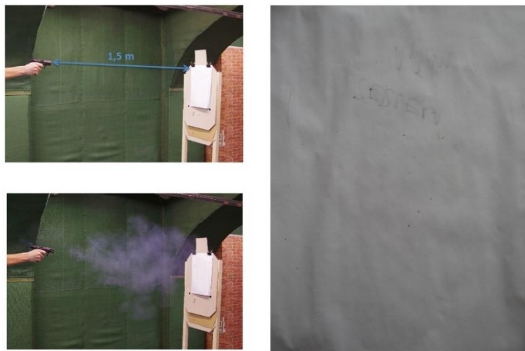
Obr. 80. Obrazec povýstřelových zplodin ze vzdálenosti 1,5 m [vlastní zdroj]
