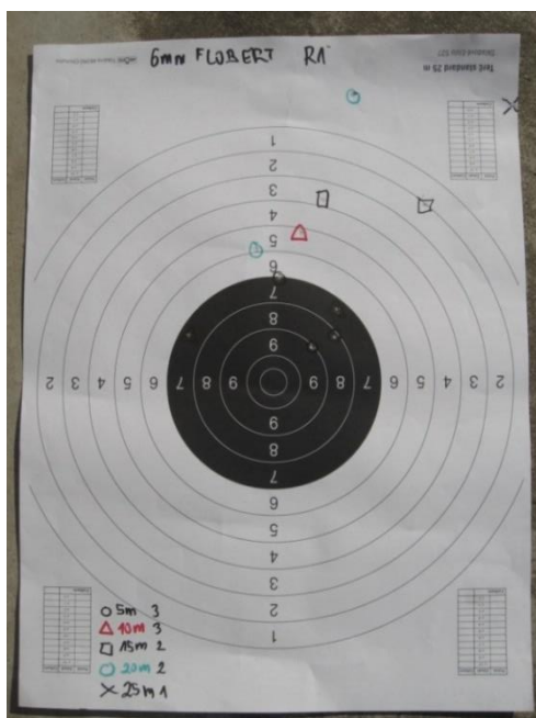
Obr. 56. Rozptyl flobertového revolveru Zoraki Streamer R1 [vlastní zdroj]
