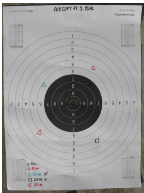
Obr. 57. Rozptyl airsoftové pistole Tokyo Mauri model CZ 75 [vlastní zdroj]
