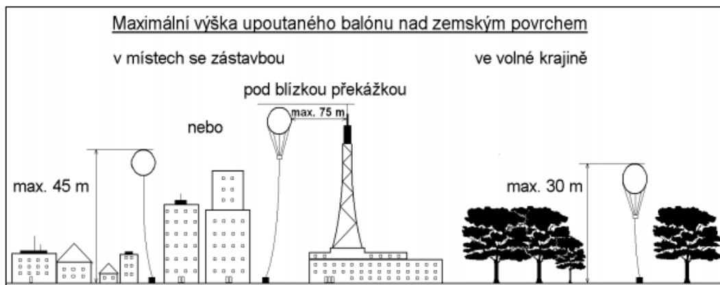
Obrázek 10 Výšková omezení upoutaného balónu bez pilota na palubě [23]
