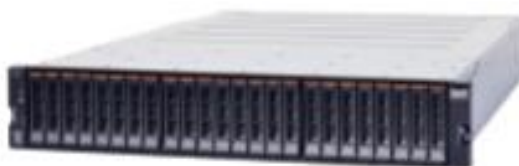
Obr. 12. Diskové pole IBM Storwize V7000 [7].
