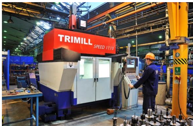
Obrázek 18: Obráběcí centrum Trimill při výrobě nástroje (interní materiály firmy)
