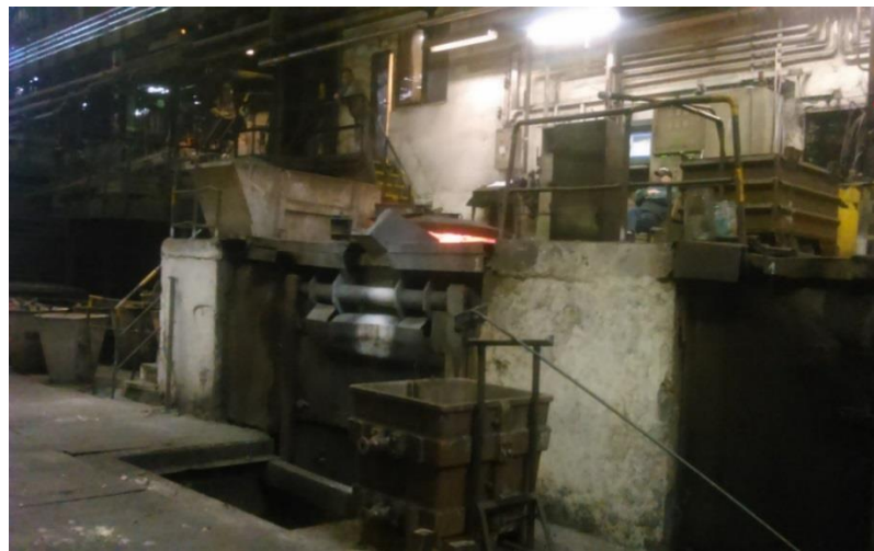
Obrázek 42 Indukční pec v ZPS – Slévárna a.s. (vlastní zpracování)
