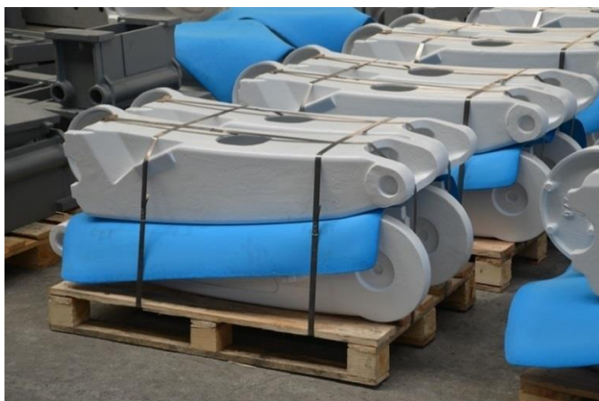
Obrázek 76 Ukotvení (ZPS – Slévárna, © 2015)
