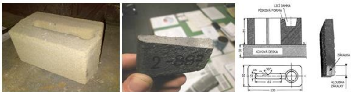
Obrázek 45 Zkouška na hloubku zákalky (interní materiály firmy)
