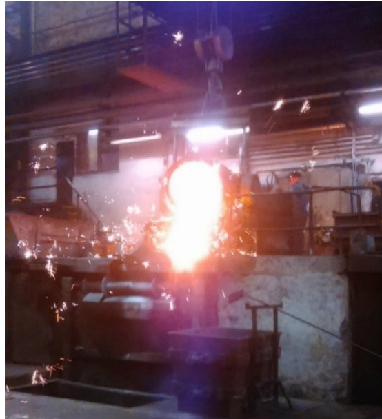
Obrázek 43 Lití roztaveného kovu do indukční pece (vlastní zpracování)
