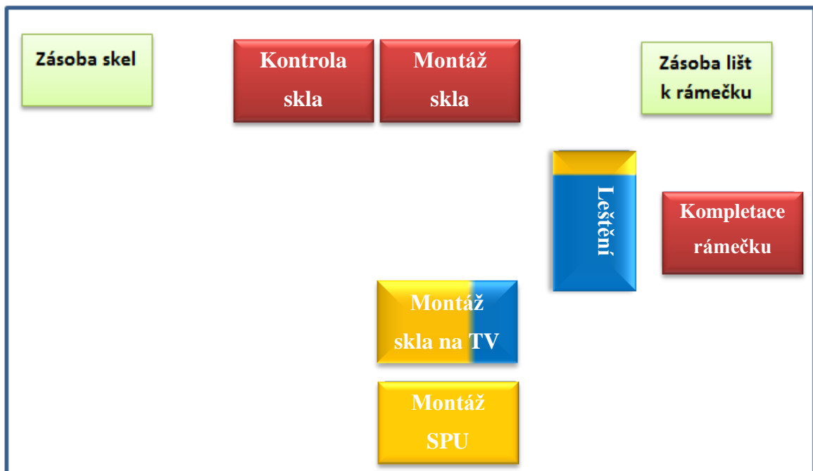
Obr. 17. Rozmístění pracoviště montážní linky č. 3 a rozdělení práce s využitím 3 operátorů (vlastní zpracování)
