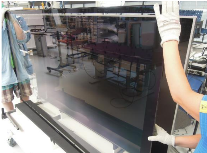
Obr. 15. Montáž skla na display (interní zdroj)
