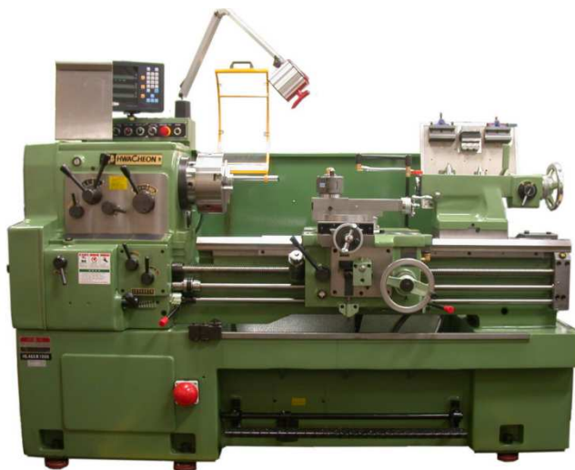
Obr. 71. Univerzální hrotový soustruh [9]
