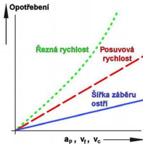
Obr. 40. Vliv řezných podmínek. [1]
