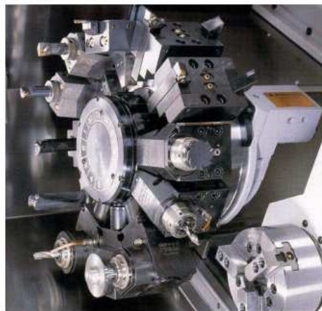
Obr. 70. Otočná revolverová hlava [13]
