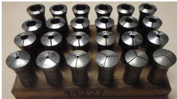
Obr. 61. Kleštiny pro různé průměry materiálu
