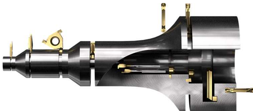
Obr. 43. Soustružnické operace s příslušnými nástroji. [12]
