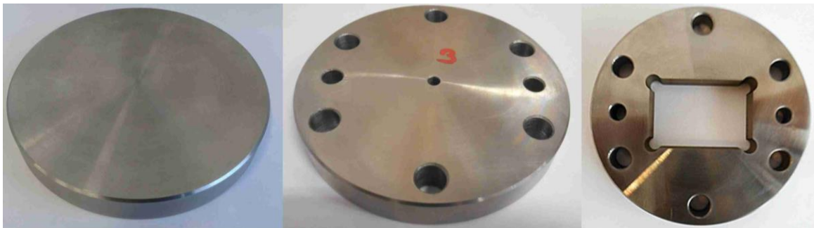
Obr. 55 Postup výroby desky 3
