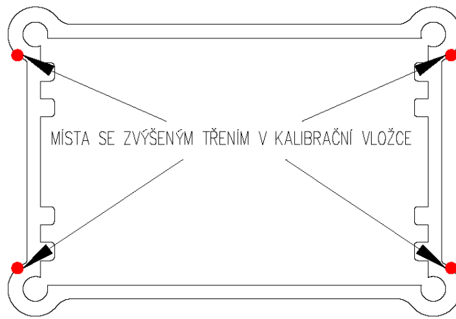
Obr. 65 Zkouška číslo 3 – místa se zvýšeným třením
