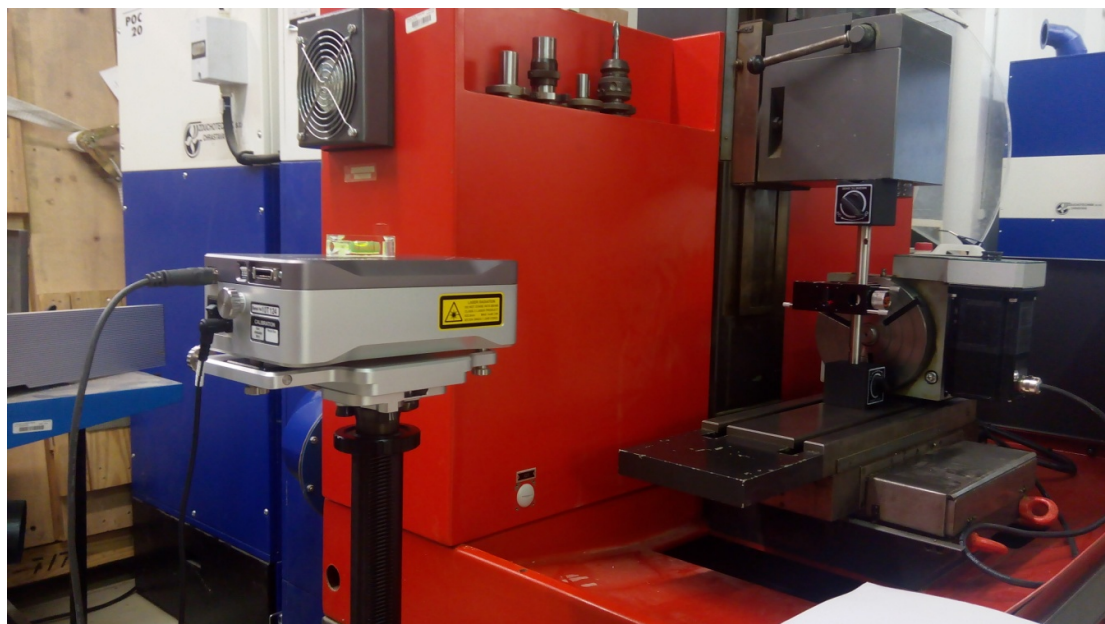
Obr. 23 Nastavenie laserinterferometra v meranej osi x
