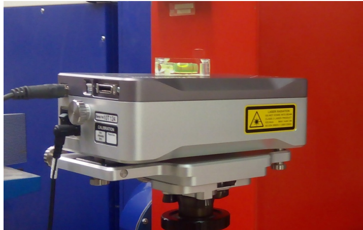
Obr. 22 Kontrola horizontálnej polohy zdroja laserového lúča pomocou vodováhy
