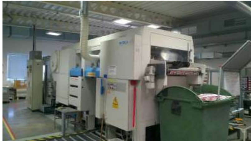
Obrázok 8 Výsekový automat Iberica JRK-105 (vlastné spracovanie)
