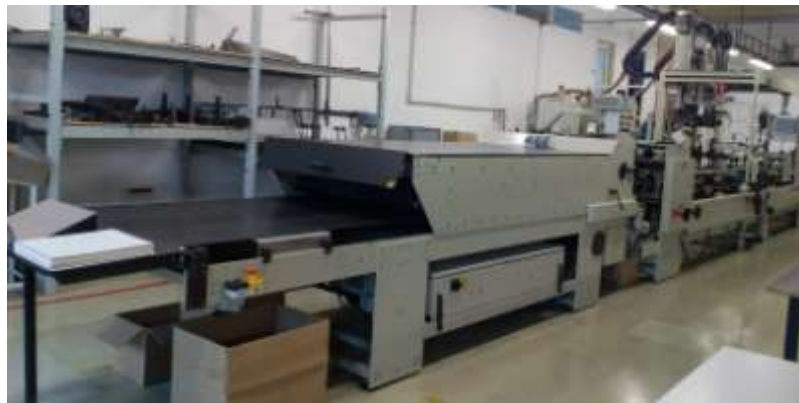
Obrázok 9 Lepiaci stroj - Heidelberg Eco 105 (vlastné spracovanie)
