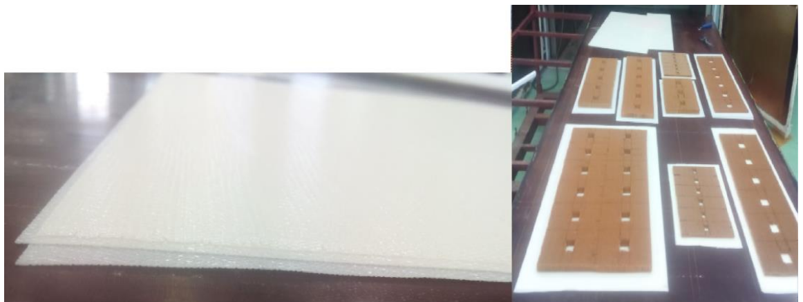
Obr. 34. 4 vrstvy prepregu a následné aplikování voštin na prepregy
