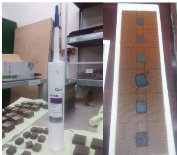
Obr. 36. Použitý tmel a aplikované vložky 40 x 40 mm, s tmelem a bez tmelu
