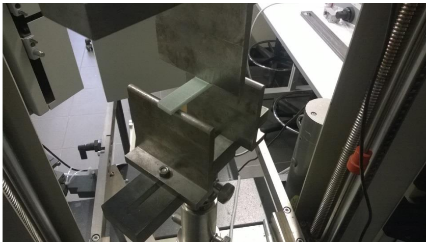
Obrázek 35 Tříbodová ohybová zkouška
