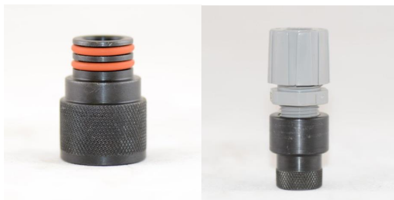
Obrázek 39 Vlevo vakuový port, vpravo vtoková vložka
