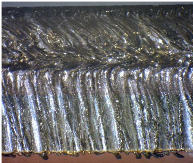
Obr. 36 Řez materiálu 17 240, tloušťka 8 mm, obráběného na vláknovém laseru s řeznými parametry dodanými výrobcem
