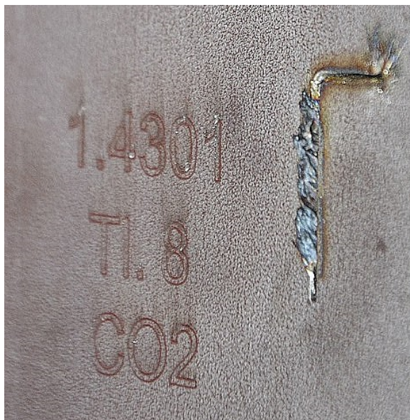
Obr. 66 Řez materiálu 17 240, tloušťka 8 mm, obráběného na CO 2 laseru s řeznými parametry dodanými výrobcem.
