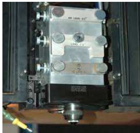
Obr. 27. Řezná hlava a tryska Platino [13]
