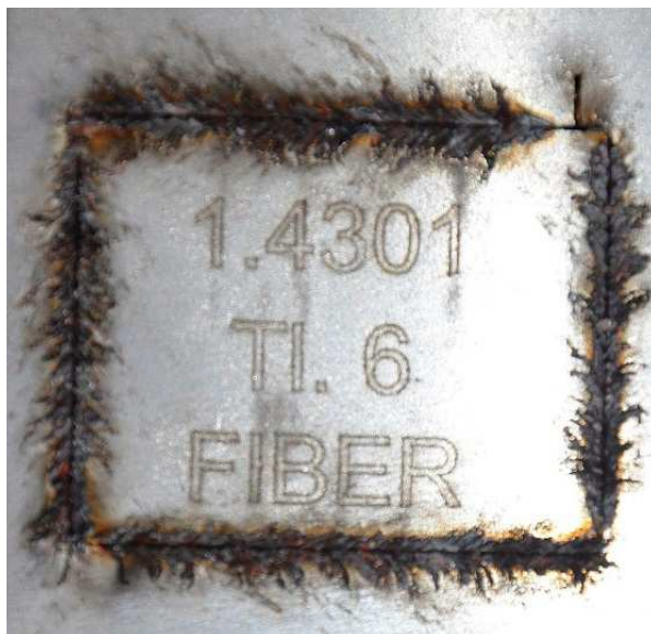
Obr. 35 Řez materiálu 17 240, tloušťka 6 mm, obráběného na vláknovém laseru s řeznými parametry i dodanými výrobcem.
