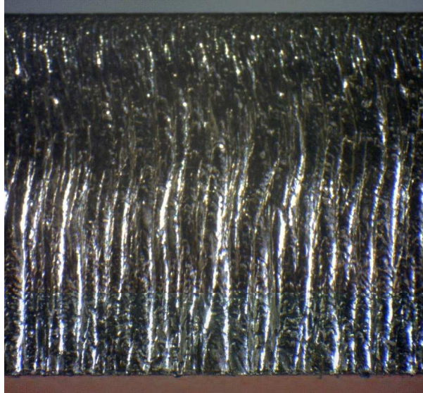
Obr. 53 Řez materiálu 17 240 tloušťka 6 mm, obráběného na vláknovém laseru s optimalizovanými řeznými parametry.
