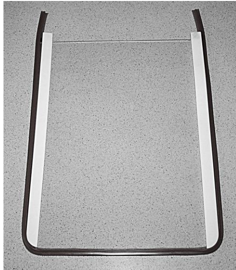
Obrázek 6: Sestavování aparatury pro přípravu gelu
