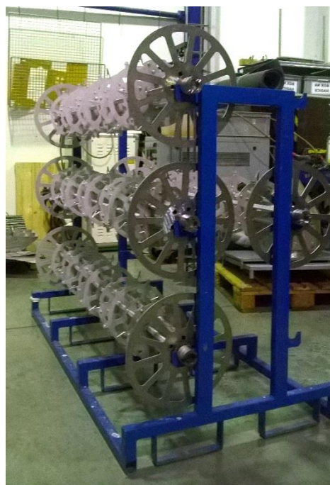
Obr. 28 Speciální držák na pokovovací přípravky (planety)
