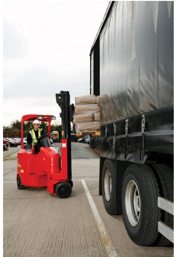
Obr. 54 Vykládka a nakládka pomocí vozíku Flexi [44]
