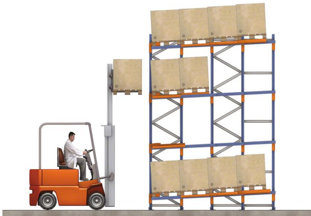
Obr. 17 Systém regálů Push-Back [22]
