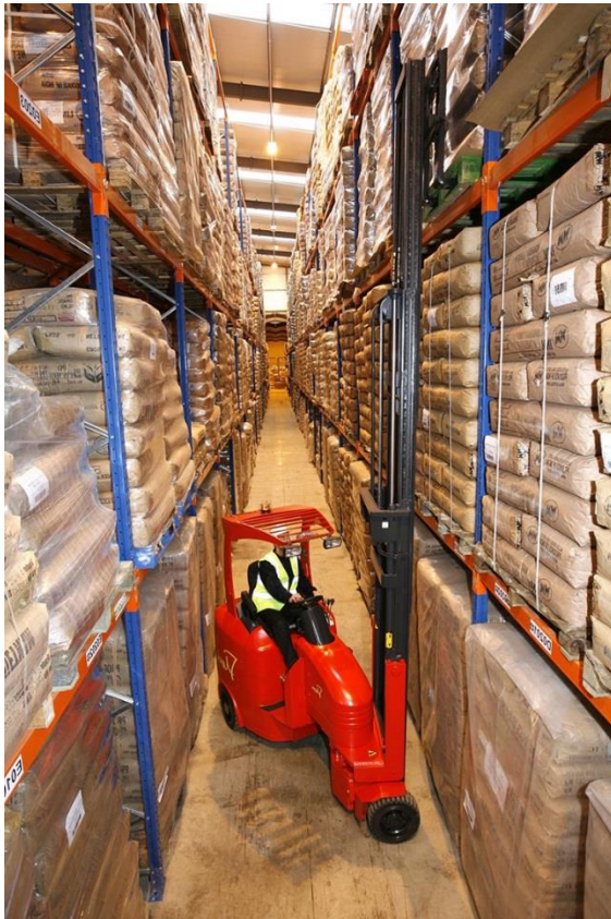
Obr. 53 Uložení palety do regálu pomocí vozíku Flexi [44]
